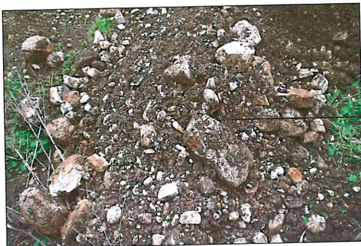
materiali di risulta dello scavo a circa – 1.8 m dal p.c.a.
